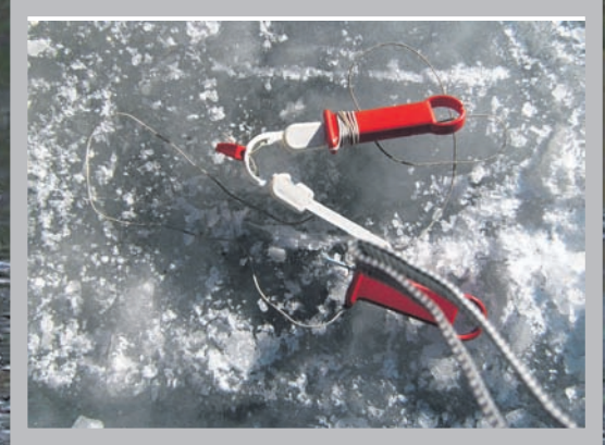
Am roten Griff des Geräts steckt ein starker «Nagel», mit welchem man sich im Eis festkrallen kann.
