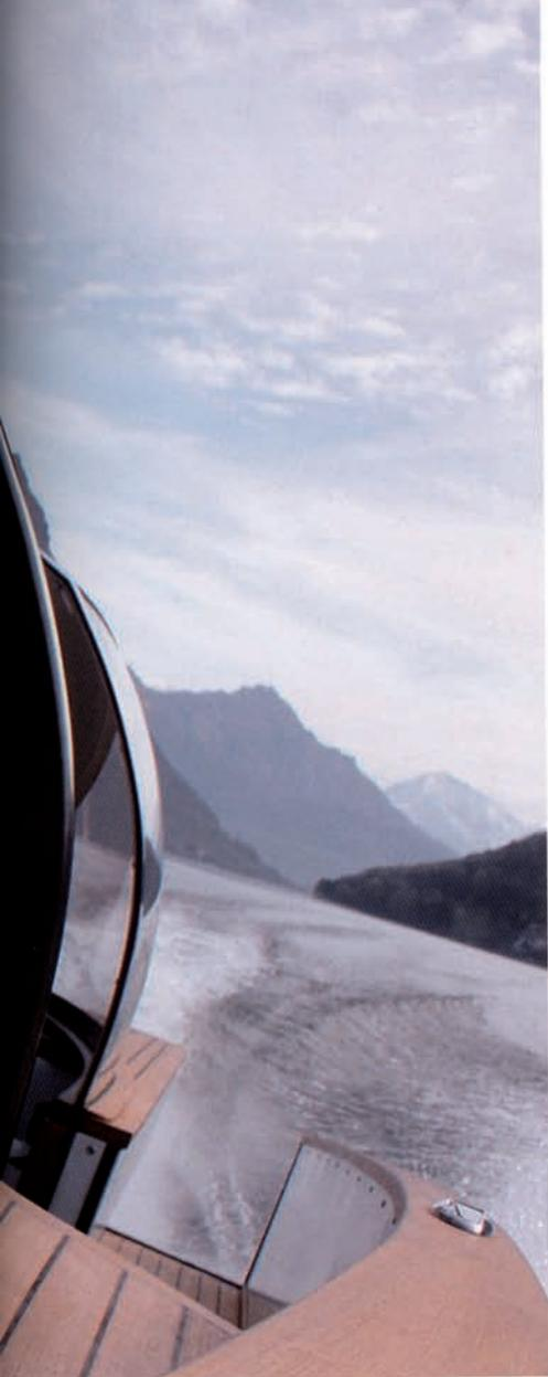
dreidimensional gebogene Frontscheibe fest und der hintere Bereich lässt sich mittels Elektromotoren (sie sind von einem Spitalbett entliehen worden) als komplette Einheit verschieben dazu genügt ein einfacher Tastendruck auf den Schlüssel. So wird der Zugang freigegeben oder während der Fahrt das Bedürfnis nach Frischluft gestillt.
