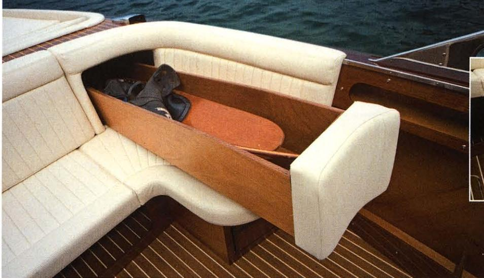
**SOPRA** il cassetto pensato per lo stivaggio dell'attrezzatura da sci e, posto appena sotto, il comodo vano frigo anch'esso a scorrere
